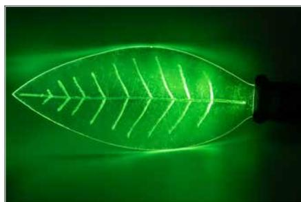
*Durch das einfallende Licht in das Acrylglas werden die gravierten Spuren angeleuchtet und heben sich deutlich von der glatten Fläche ab. Mittels Farbfolie können Sie hier dem Blade zusätzlich eine beliebige Farbe geben.*
